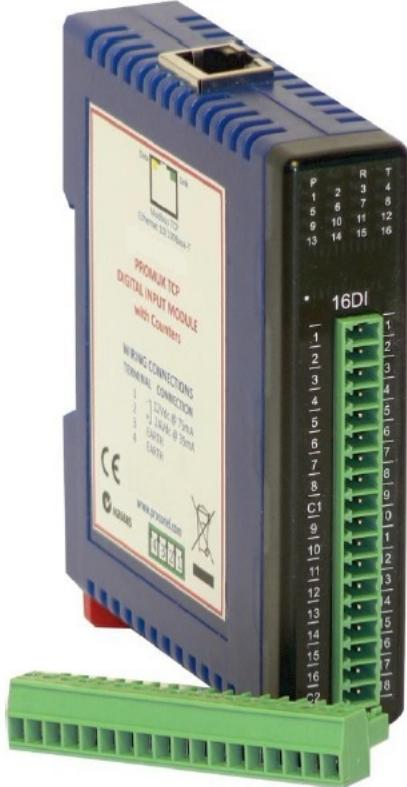
TCP-16DI 제품은 사용자 설정에 따라 2가지 모드의 카운터로 동작합니다. 첫번째 모드는 32비트 카운터로 동작하며 0부터 4294967295 사이의 값을 카운트 합니다. 카운트 값을 해당 레지스터에 '0' 값을 입력하여 초기화 할 수 있습니다. 두번째 모드는 UP/DOWN 카운터로 동작하며 1번과 2번 채널 입력이 카운터1에 연결됩니다. 1번 채널에 신호가 입력되면 카운터1 값이 증가하고 2번 채널에 신호가 입력되면 카운터1 값이 감소합니다. 동일한 방식으로 3번과 4번 채널은 카운터2에 연결되고 5번과 6번 채널은 카운터3, 7번과 8번 채널은 카운터4에 연결됩니다. TCP-16DI 제품은 배터리 백업 기능을 지원하지 않기 때문에 전원 연결이 끊어질 경우 기록된 카운트 값을 유지할 수 없습니다.
