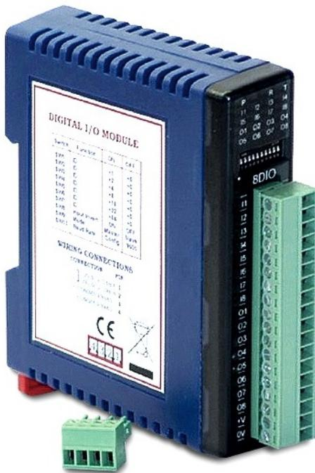
디지털 입력 인터페이스는 사용자 설정에 따라 32비트 카운터로 동작하며 0부터 4294967295 사이의 값을 카운트 합니다. 카운트 값은 해당 레지스터에 '0' 값을 입력하여 초기화 할 수 있습니다. RTU-8DIO 제품은 배터리 백업 기능을 지원하지 않기 때문에 전원 연결이 끊어질 경우 기록된 카운트 값을 유지할 수 없습니다.
