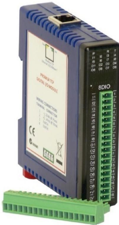
디지털 입력 인터페이스는 사용자 설정에 따라 32비트 카운터로 동작하며 0부터 4294967295 사이의 값을 카운트 합니다. 카운트 값은 해당 레지스터에 '0' 값을 입력하여 초기화 할 수 있습니다. TCP-8DIO 제품은 배터리 백업 기능을 지원하지 않기 때문에 전원 연결이 끊어질 경우 기록된 카운트 값을 유지할 수 없습니다.
