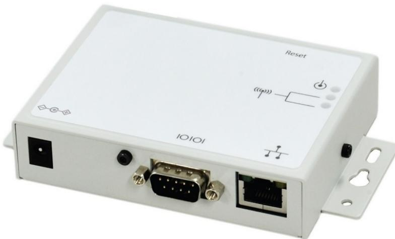
SD-300 제품은 3가지 모드를 사용하여 시리얼 데이터를 송수신 합니다. Serial Port Emulation 모드는 윈도우즈 운영체제 기반의 PC에 가상 COM 포트를 생성하고 시리얼 데이터를 송수신 합니다. 따라서 기존에 COM API 기반으로 작성된 프로그램을 수정하지 않고 그대로 사용할 수 있습니다. Raw TCP Connection 모드는 TCP 소켓 서버 모드로 동작하며 사용자 시스템은 TCP 클라이언트 모드로 동작합니다. TCP 소켓이 연결되면 시리얼 데이터 프레임이 변경되지 않고 그대로 전달됩니다. eCable 모드는 2개의 SD-300 제품을 Point-to-Point 방식으로 연결하며 RS232 시리얼 장치 사이를 이더넷 네트워크로 연결합니다.
